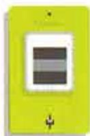
> En cas de détection d'une surtension sur le réseau, le compteur coupe l'alimentation afin d'éviter d'éventuels dommages aux appareils électriques de mon logement.
